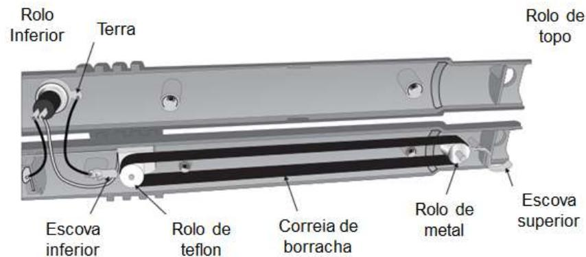
**Figura 3** – Funcionamento interno do *Fun Fly Stick*.
