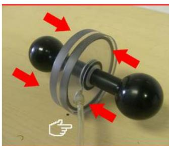
**Figura 2** – Forças de pressão na superfície exterior dos discos de Magdeburgo
